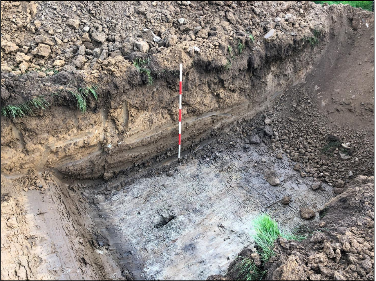
Eksempel på det ganske tykke pålagte lerlag som de fleste steder var mellem 1 og 2 meter tykt.
